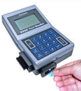
Do 3 minut od dokončení testu vložte čistý a vizuálně zkонтrolovaný strip do čtečky Rosa jak je znázorněno. Zasuňte jej celý do otvoru.
